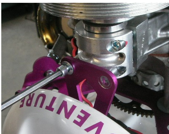
7 Remontage du chapeau
